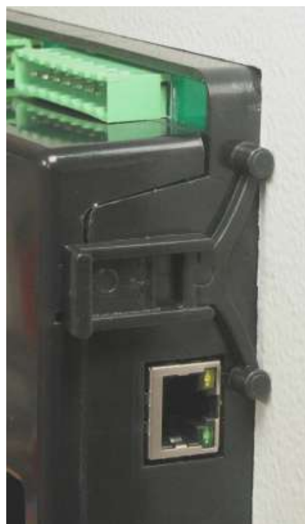
Установка самоудерживающегося кронштейна
