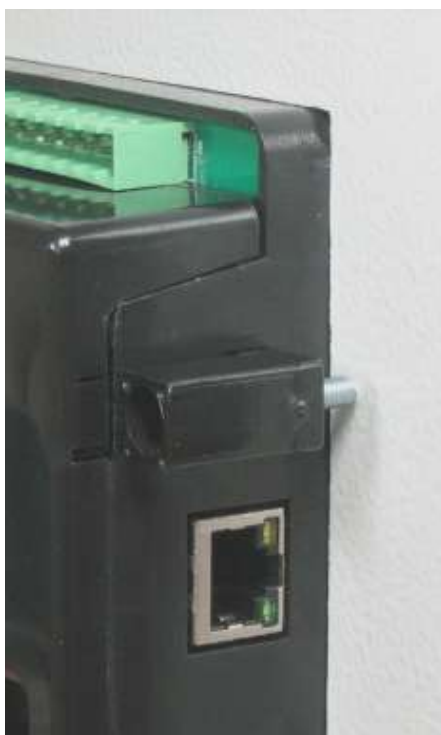
Установка кронштейна винтового типа
